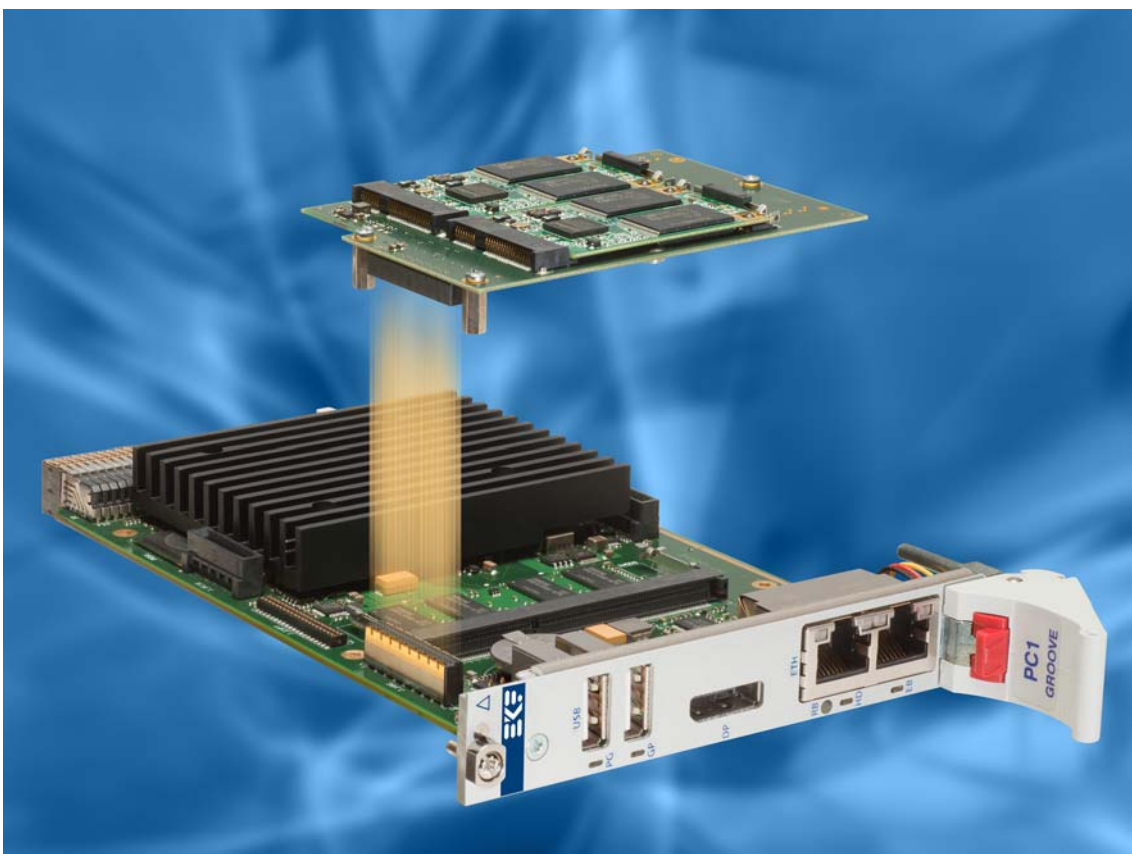
C47-MSATA Dual mSATA SSD Module
